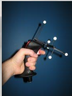
Flystick1 à 5 boules réfléchissantes
