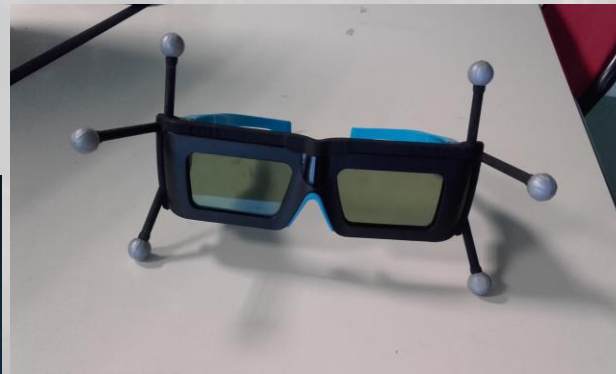
Lunette 3d Volfoni Edge, munie de 6 boules réfléchissantes
