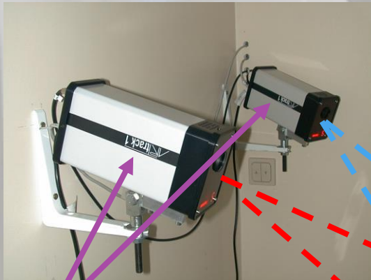
2 caméras ARTTrack1 C01 et C02 synchronisées
