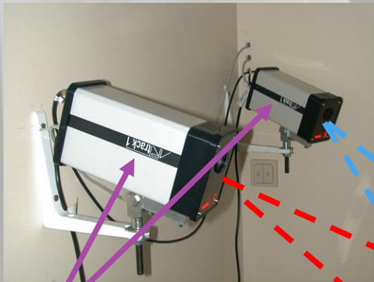
2 caméras ARTTrack1 C01 et C02 synchronisées
