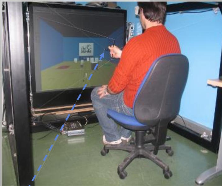
Moteur/encodeur + poulie pour chacun des coins du cube.
